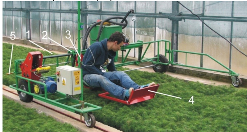
Obr. 11. Sejačka SPS využitá pri pletí. 1 – hlavný rám, 2 – rám na nesenie náradia, 3 – sedadlo 4 – podložka pod nohy so spínačom, 5 – skrutkový mechanizmus na presun rámu na nesenie náradia.
