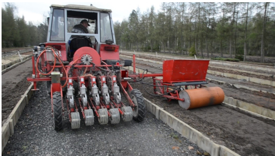
Obr. 3. Agregát upevnený na vysunutom ráme sejačky počas práce v rámoch
