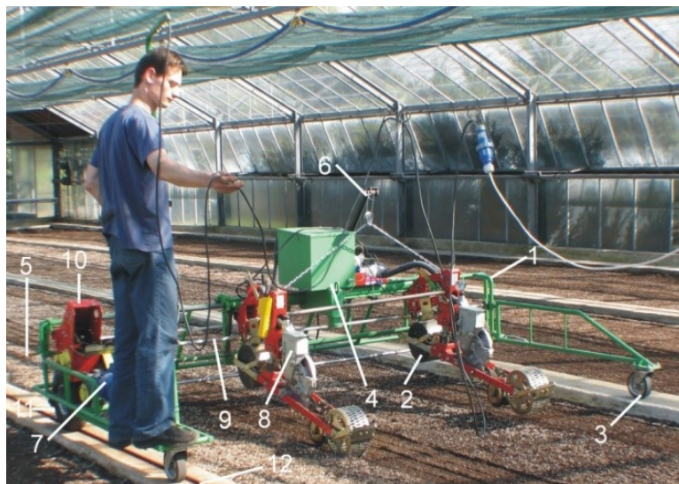
Obr. 10. Sejačka SPS na výsev v skleníku alebo fóliovom kryte. 1 – hlavný rám, 2 – hnacie koleso, 3 – oporné koleso, 4 – rám na nesenie náradia, 5 – skrutkový mechanizmus na posun, 6 – zdvíhací mechanizmus, 7 – hnací elektromotor, 8 – výsevne sekcie, 9 hnací hriadeľ výsevnych sekcií, 10 – prevodovka, 11 – vodiaci behúň, 12 – vodiaca lišta.
