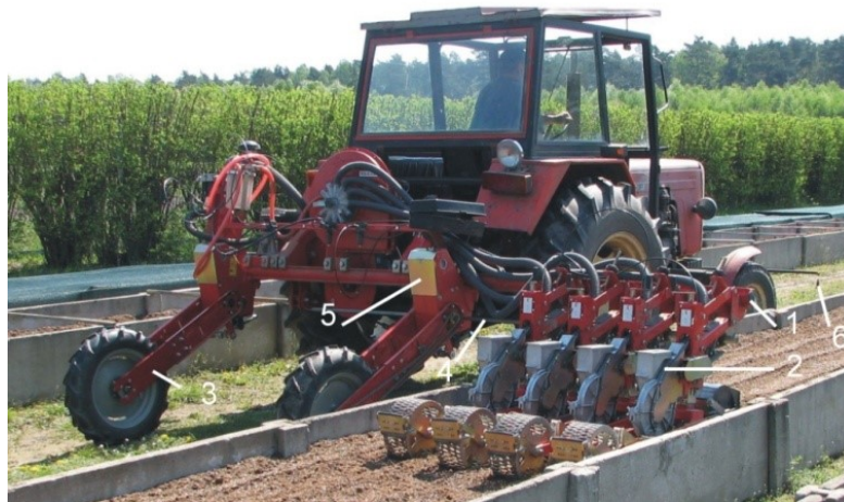
Obr. 9. Sejačka SPS na výsev v rámoch. 1 – bočné predĺženie rámu, 2 – výsevné sekcie sejačky, 3 – ramená oporných kolies, 4 – hnací hriadeľ, 5 – prevodovka, 6 – senzor pohybu traktora
