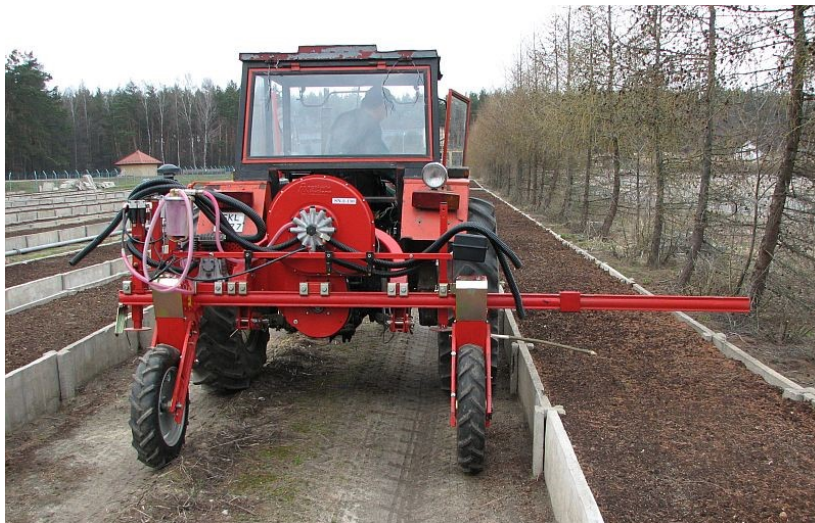
Obr. 2. Rám sejačky SPS na hnojenie, mykORIZáciu, prípravu pôdy a presný výsev v rámoch
