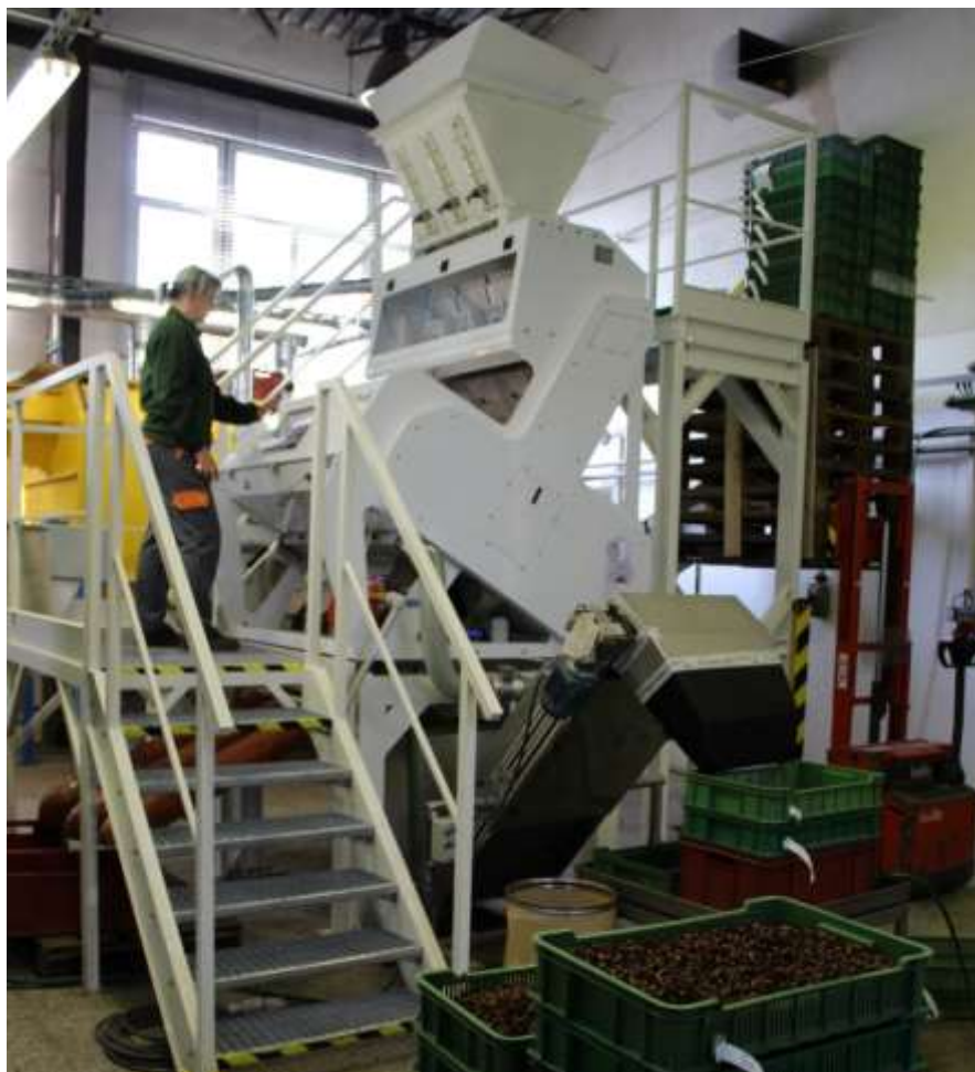
Obrázek 4 Optický třídič v Semenářském závodě v Týništi nad Orlicí
