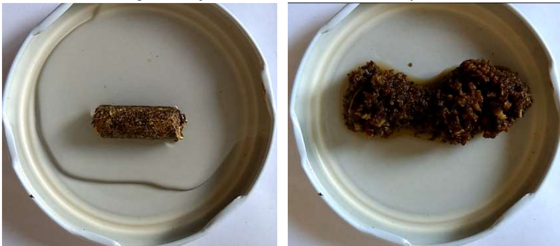
Obr.9: Retenční schopnost hnojiva PELETSEP nasát 10 ml vody během 15 minut
