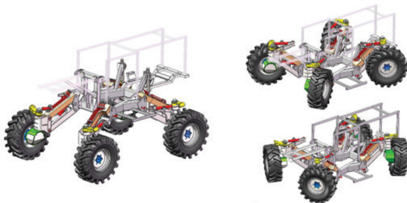
Obr. 2 CAD3D model plošinového podvozku
