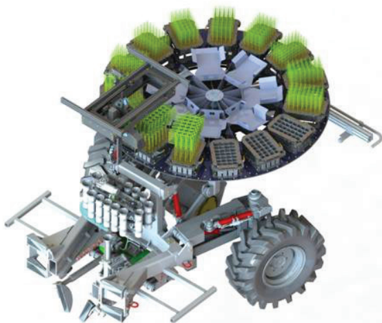
Obr. 5 Pohled na CAD-3D model sestavy manipulátoru namontované na vozidle
