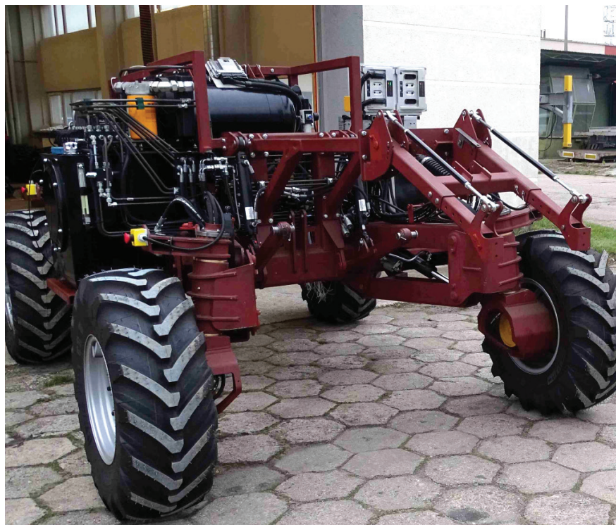
Obr. 7 Mobilní platforma automatického sázecího stroje při funkčních zkouškách
