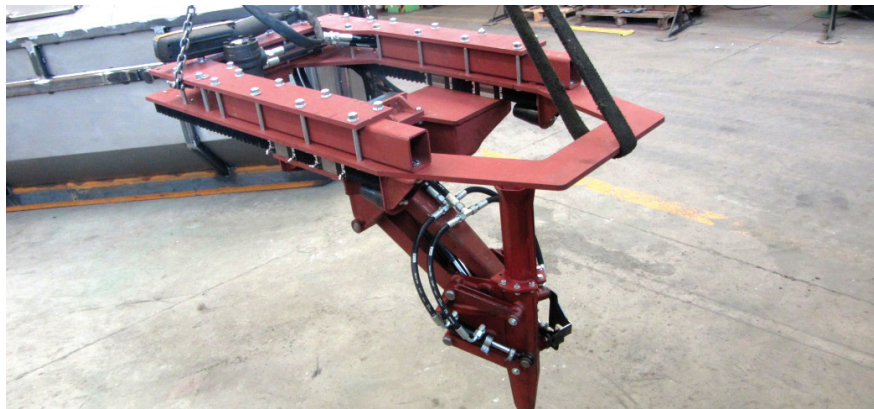
Obr. 6 Sestavený výzkumný model saze e se systémem silové hydrauliky
