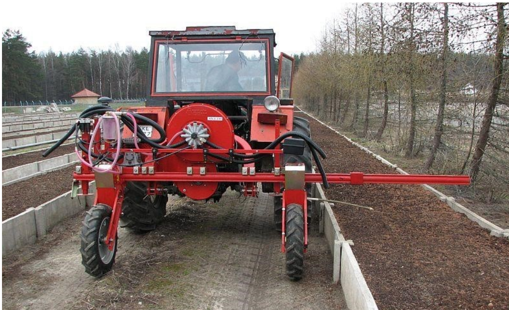
Obr. 5: Bočné predĺženie rámu výsevového stroja
