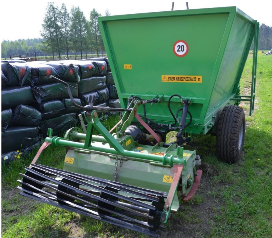
Obr. 10: Dávkoč subštrátu do otvorenej řnkôlky
