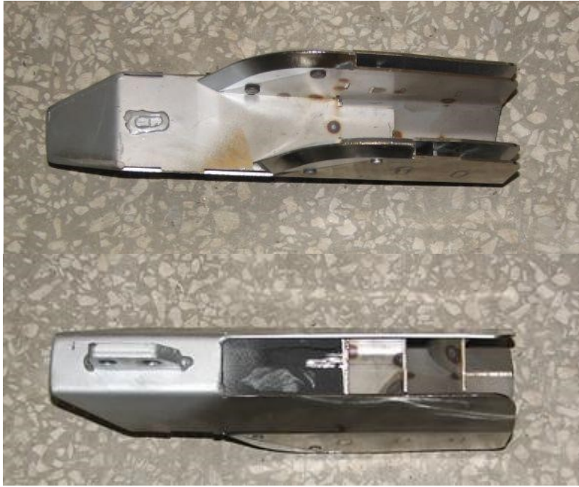
Obr. 8: Pätká na dvojriadkový výsev jednou sekciou sejacieho stroja
