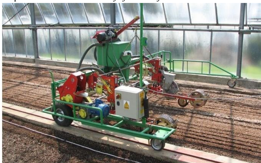
Obr. 12: Sekcie sejacieho stroja na presný výsev namotnované na nosiči náradia počas práce v skleníku
