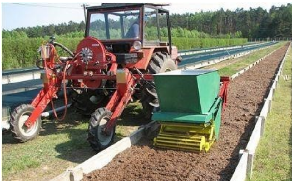
Obr. 6: Dávkovač biopreparátu a granulovaného hnojiva
