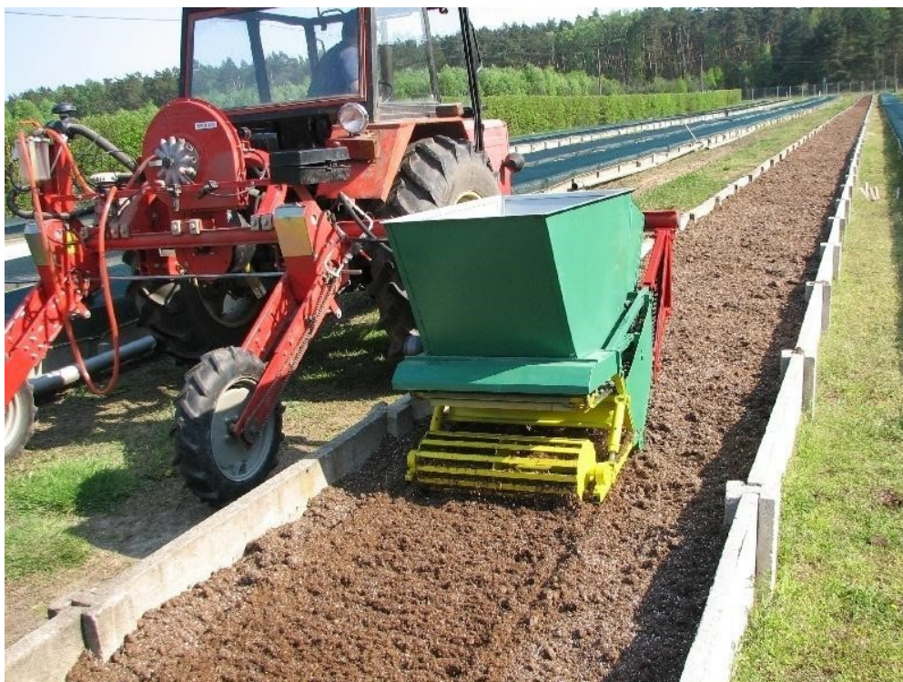
Obr. 11: Dávkoč hnojív spojený s rotavátorom a valcom
