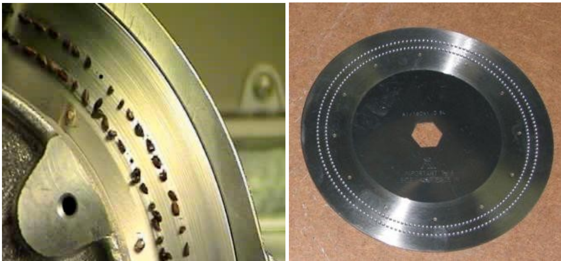
Obr. 9: Dvojradový disk na výsev semien borovice
