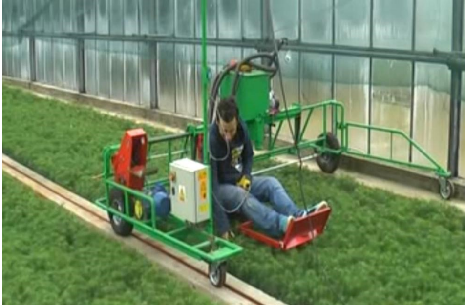
Obr. 14: Pletie vysiateho záhona v skleníku s využitím sedadla a nosiča náradia
